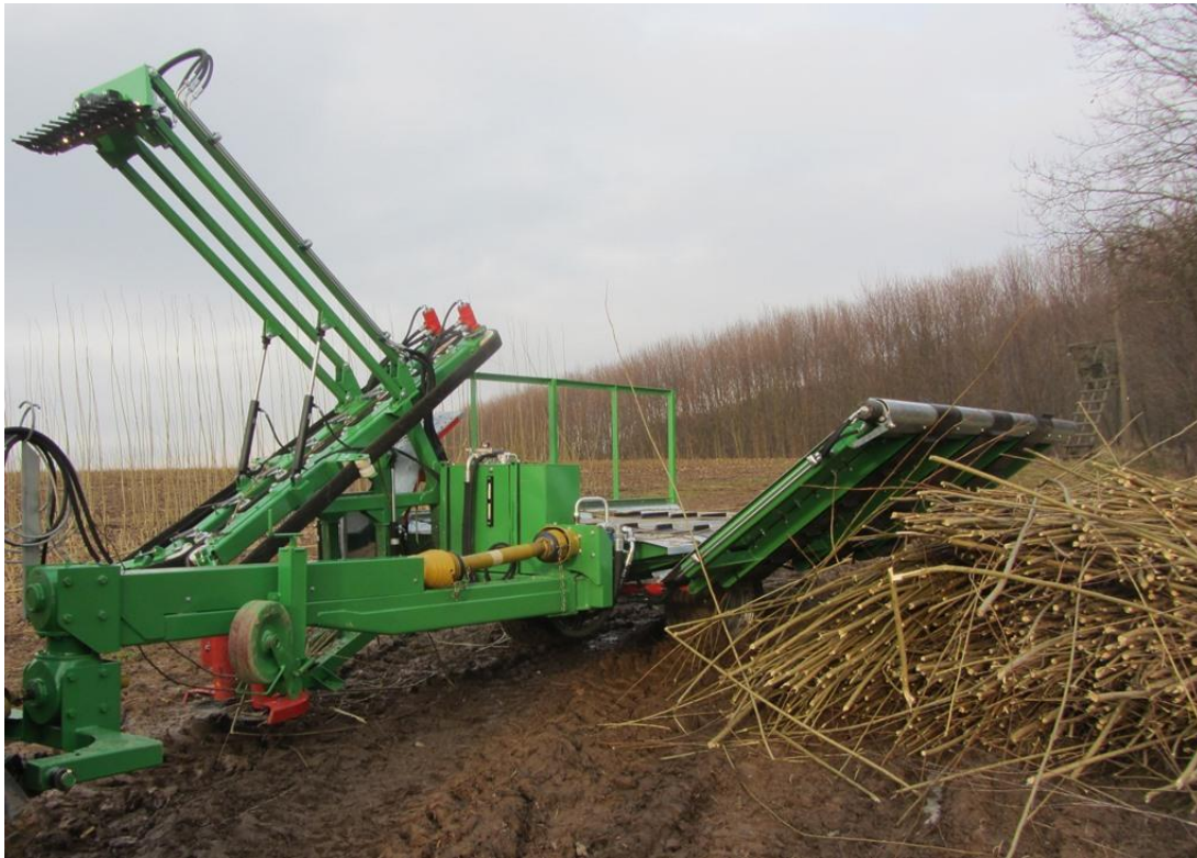
Abbildung 1: ROD-PICKER Erntemodul, Einsatz im Pappel Mutterquartier
